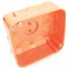
**HWDW**, přístrojová krabice; oranžová (RAL 2004), rozteč šroubů 60 mm, požadovaný montážní otvor Ø 68 mm, vnější obruba krabice Ø 71 mm, pro desky tl. 7-35 mm, max. pripojení 4 hadic Ø 20 mm a 2 kabelů, ideální pro instalace v pasivních domech
