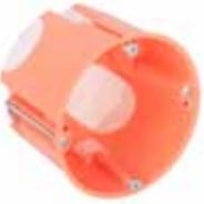
**HWADW**, rozbočná přístrojová krabice; oranžová (RAL 2004), požadovaný montážní otvor Ø 121 mm, vnější obruba krabice Ø 126 mm, pro desky tl. 7-35 mm, max. pripojení 3 hadic Ø 20 mm, 3 hadic Ø 25 mm a 3 kabelů
