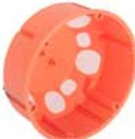
**HWAK**, rozbočovacia krabica; oranžová (RAL 2004), potrebný inštaláčny otvor 4x Ø 35 mm, vonkajší lem krabice 107x107 mm, pre podklady hrubé 7-35 mm, max. pripojenie 8 ochranných rúrok Ø 20 mm a 6 káblov, s vodiacou drážkou pre zasunutie oddelovacích prepážok a predznačené body pre frézovanie otvorov
