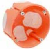
**HWADW**, rozbočná přístrojová krabice; oranžová (RAL 2004), rozteč šroubů 60 mm, požadovaný montážní otvor Ø 68 mm, vnější obruba krabice Ø 71 mm, pro desky tl. 7-35 mm, max. pripojení 4 hadic Ø 20 mm, 2 hadic Ø 25 mm a 4 kabelů
