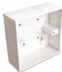
**SHB 20/1**, rozbočovacia krabica na povrch, pre 1 pribor, podla anglickych norem; biela (RAL 9010), vzdialenosť otvorov pre upevňovacie skrutky 60 mm, otvory pre skrutky s mosadznou vložkou, predlisované otvory 1x pre ochrannú rúrku a 1x pre žlab
