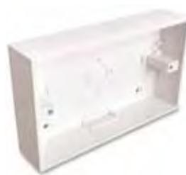
**SHB 20/2**, rozbočovacia krabica na povrch, pre 2 pribory, podla anglickych norem; biela (RAL 9010), vzdialenosť otvorov pre upevňovacie skrutky 60 mm, otvory pre skrutky s mosadznou vložkou, predlisované otvory 1x pre ochrannú rúrku a 1x pre žlab
