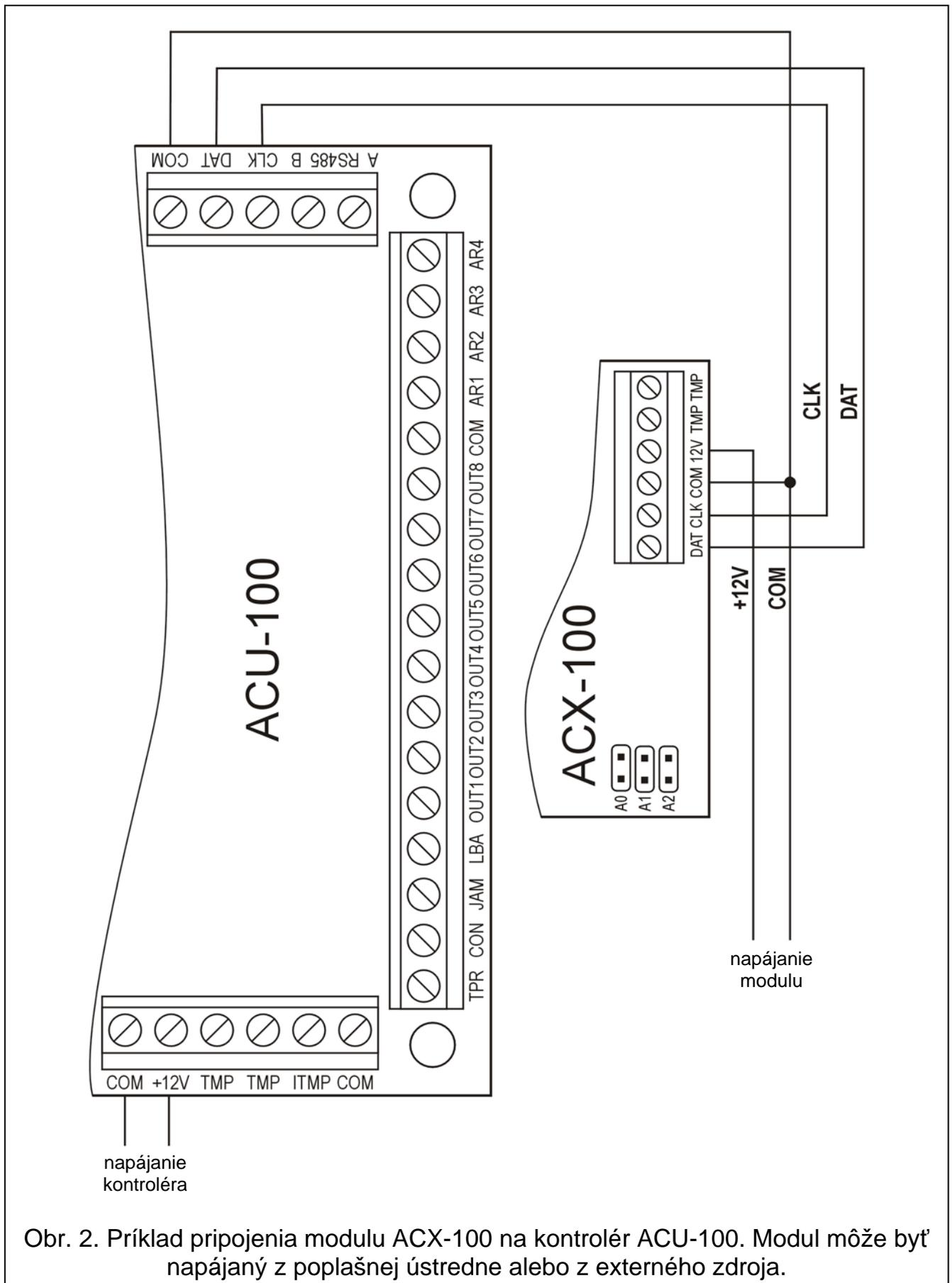
Obr. 2. Príklad pripojenia modulu ACX-100 na kontrolér ACU-100. Modul môže byť napájaný z poplašnej ústredne alebo z externého zdroja.
