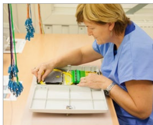
Introducing pigtails into a optical cassettes Zavádění pigtailů do optických kazet
